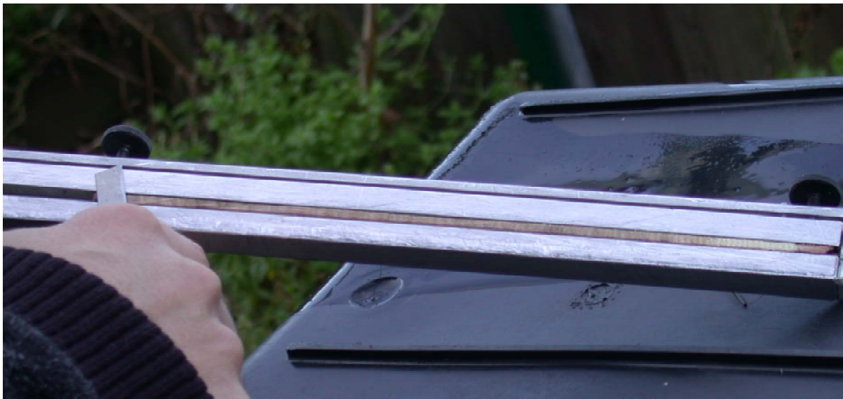
Eine unserer ersten Schneideschienen für die Präparation der frisch gezogenen Bohrkern zur Sichtbarmachung der Jahrringe im Gelände (um 1980).
