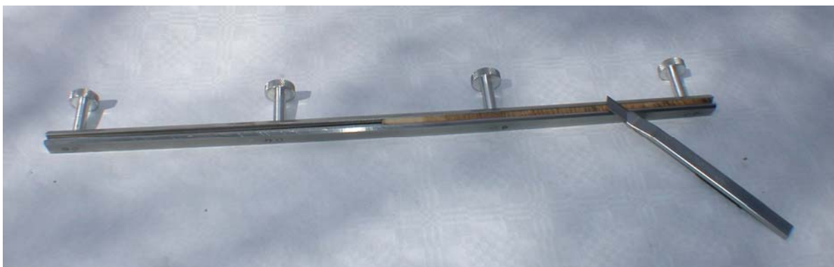
Weiterentwicklung der Schneideschienen für die Präparation von frisch gezogenen Bohrkernen im Gelände (ab 1993)
